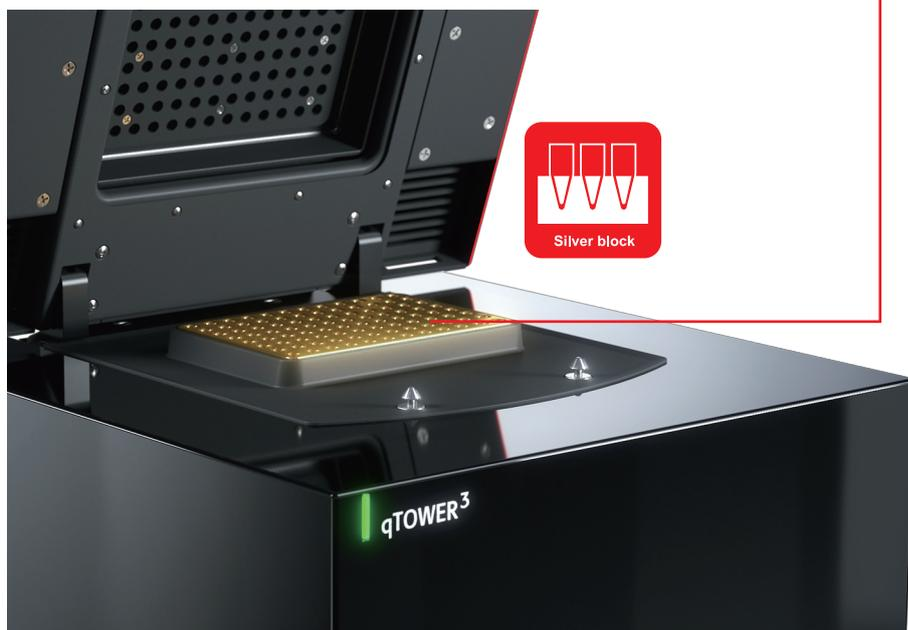
镀金纯银槽，传热速度快，耐腐蚀抗氧化
