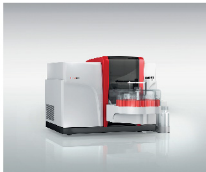
contrAA 系列 高分辨率连续光源原子吸收，快速顺序测量以及同时多元素分析的同时背景校正技术
